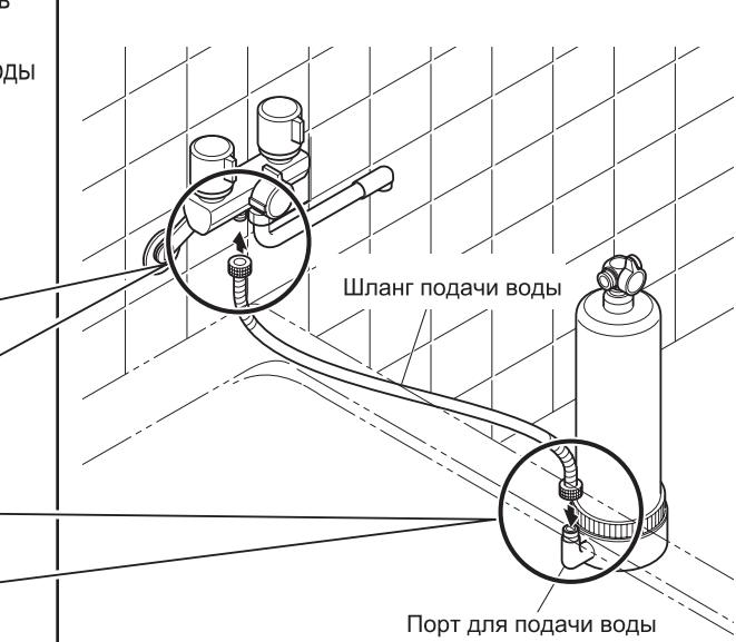
3 Установите прилагаемое кольцо с креплением и с присоской на устройство. (При монтаже кольца с креплением заранее определите позицию установки блока.)
