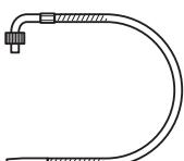
① Выпуская труба горячей воды (480 мм в длину)
