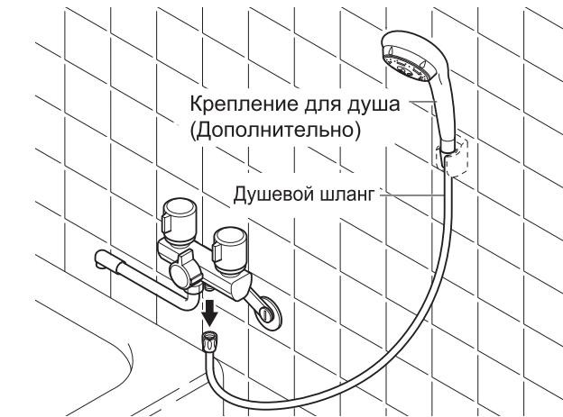
2 Установите прилагаемый шланг для подачи воды в порт для подачи воды на устройство и монтажную часть душа. При соединении шланга для подачи воды с монтажной частью душа, когда незначительный диаметр резьбы не подходит, пожалуйста, используйте адаптер для крепления со стороны прилагаемого смесителя.
