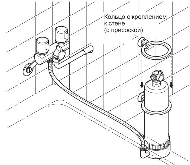
**4** Снимите защитную бумагу с пластины для адсорбции, прикрепите присоску на поверхность стены и дайте ей надежно закрепиться.
